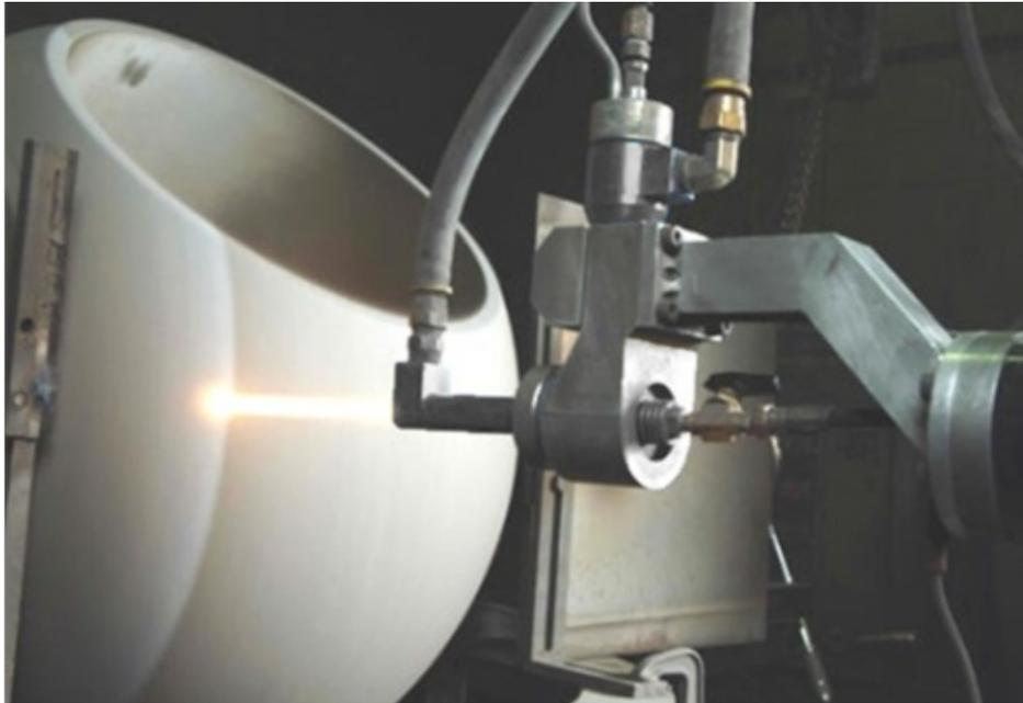
粉末等离子堆焊工艺已应用于工业制造业的多个领域,主要目的在于获得有特定性能(耐磨、耐蚀、耐高温等性能)的合金硬面层。从应用角度有以下分类:按工件堆焊面的几何形状分类。主要分为:园平面、园锥面、园柱面、园柱螺旋面、平面线段或平面等。针对不同类型的工件,在工艺控制程序上有所区别。对于复杂的平面线段(连续或不连续的直线段或曲线段),要实现全自动堆焊,就要采用数控系统。对同一类型工件,在几何尺寸上相差甚大者,则要选择相适应的机型。按工件所属的制造行业分类。根据目前的应用情况,主要有:阀门制造行业、气门制造行业、冶金轧制工具制造行业、石油机械行业、煤矿机械行业、电力机械行业等等。随着应用范围的扩大,将会有更多的制造行业在产品的修造中采用粉末等离子堆焊技术。采用等离子堆焊工艺可以延长材料的使用寿命。湖北粉末等离子堆焊系统
